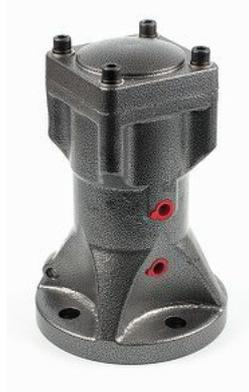
В **поршневых пневматических вибраторах** используется сжатый воздух для перемещения поршня из одного конца цилиндра к другому, тем самым создавая вибрацию. Применяются в местах, где есть серьезные ограничения по шуму.
